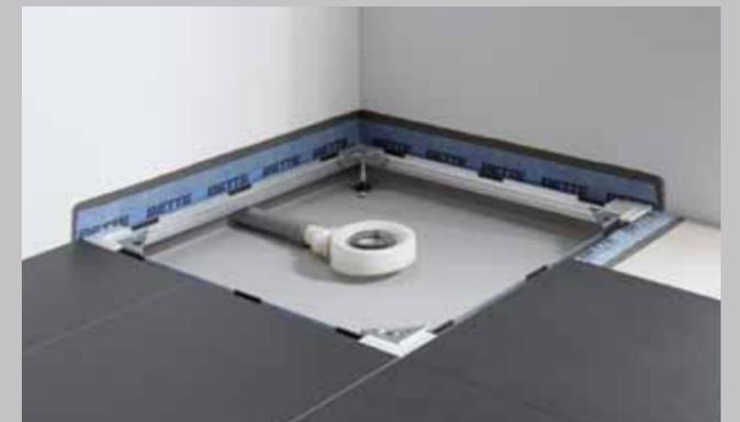
Zum Schluss wird die Duschfläche in den Rahmen eingesetzt und die Ablaufgarnitur vollständig angeschlossen. Die Fugen werden elastisch versiegelt. So bleibt die gesamte Konstruktion dauerhaft revisionsfähig.
