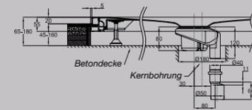
Abb.: mit senkrechter Entwässerung
