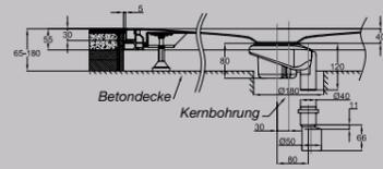
Abb.: mit senkrechter Entwässerung
