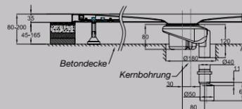
Abb.: mit senkrechter Entwässerung
